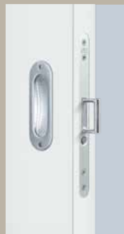
Благодаря выдвигающейся ручке Вы сможете полностью задвинуть в стену открытую раздвижную дверь. При нажатии на кнопку ручка «выпрыгнет», и Вы сможете закрыть дверь.
